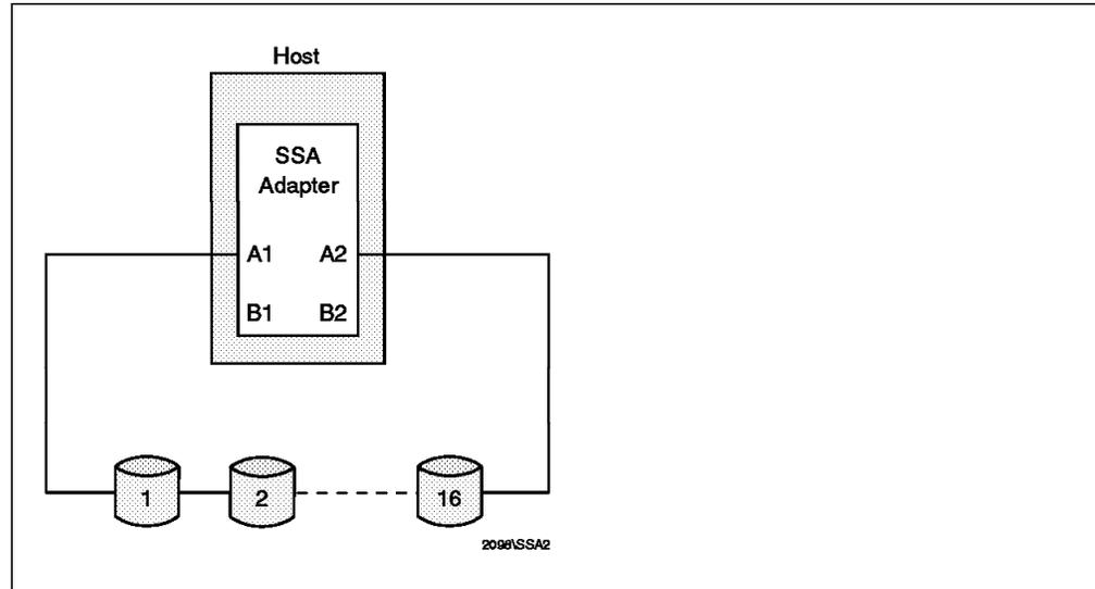
Figure 27. A Simple SSA Disk Subsystem
