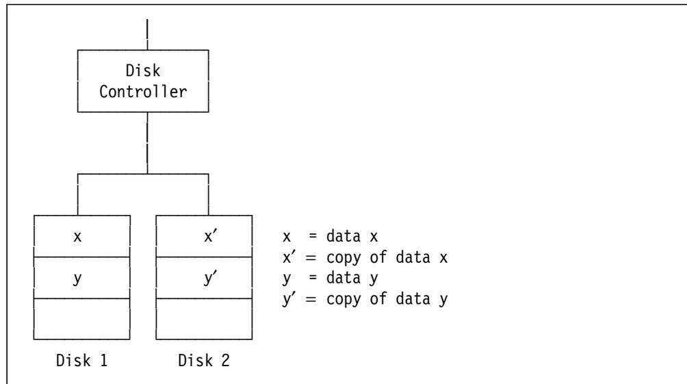
Figure 33. RAID-1 (Disk Mirroring)
